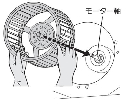
2) ファンが回らないように軽く手で押さえ、ツマミを「しめる」(反時計回りの方向に回して締め付けます。
