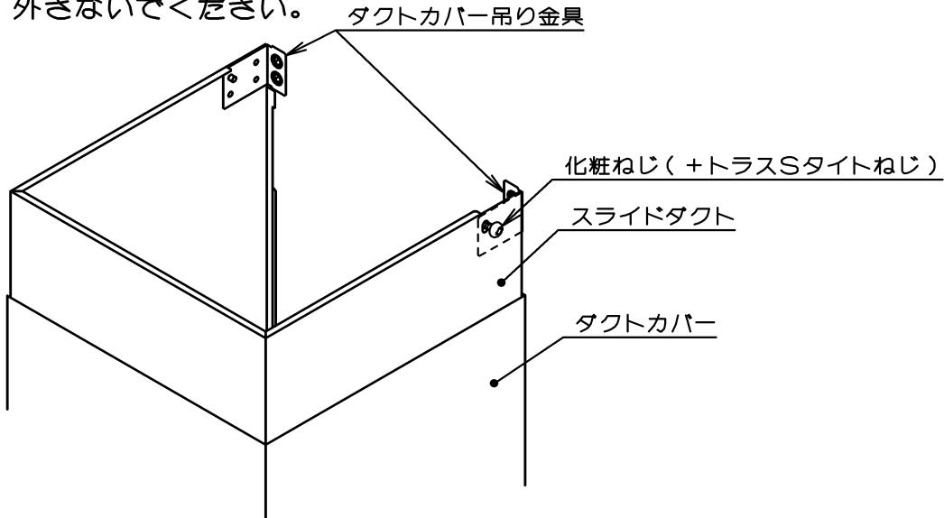
2. スライドダクトの法兰の下に①上塞板の爪を差し込み、下図の様にダクトカバー吊金具とスライドダクトの間に②上塞板の曲げ部を差し込みます。
