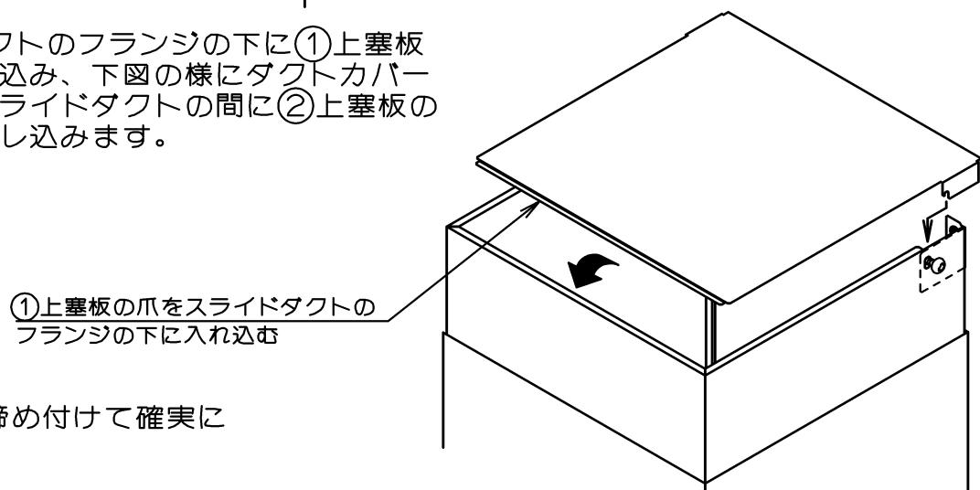
3. 化粧ねじを締め付けて確実に固定します。
